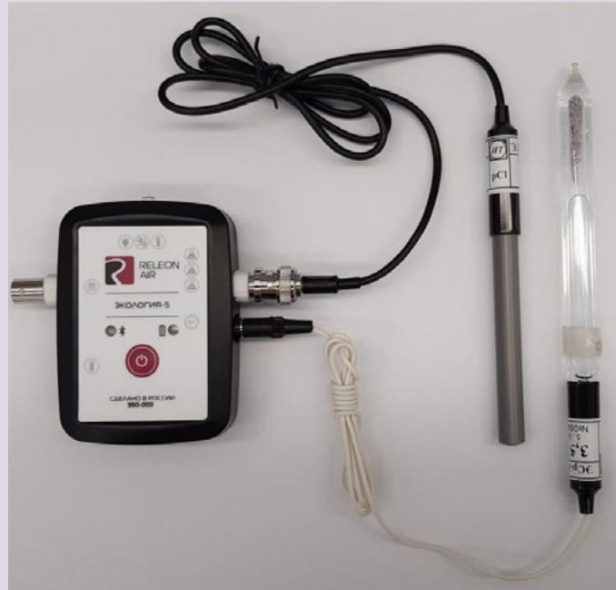
**Рис. 10.** Ионоселективный датчик
