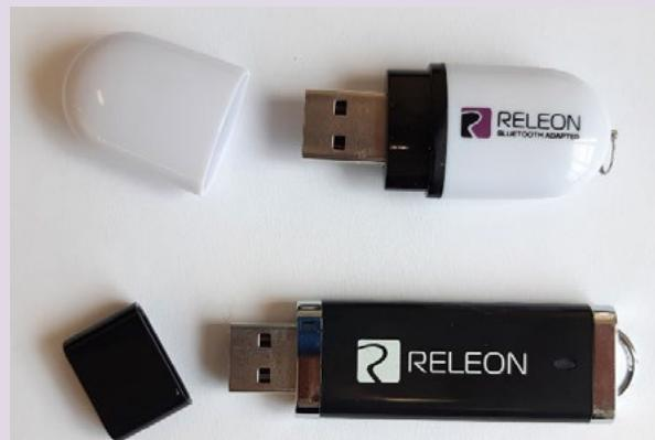
**Рис. 13.** Общий вид USB-флеш-накопителя (внизу) и Bluetooth-адаптера (вверху)
